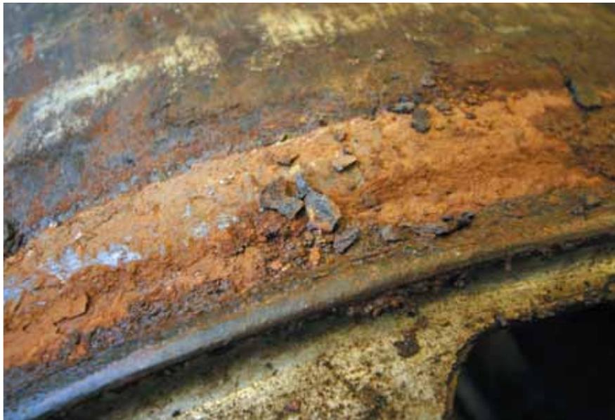
*Стальные колеса, изготовленные методом штамповки, подвержены коррозии. Причем ржавчина поражает не только внешние части диска и обода, но и внутренние. В последнем случае виновата влага, которая конденсируется внутри шины. На эксплуатационные качества колеса коррозия практически не влияет. Окалину, как правило, счищают в процессе шиномонтажа. При этом мастер должен удостовериться в отсутствии под слоем ржавчины трещин*
