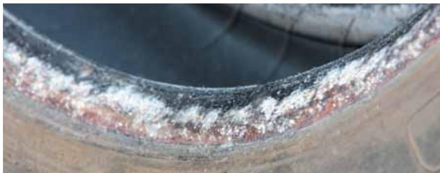
*На посадочной плоскости шины видны следы краски, которая осталась после ее демонтажа с колеса. Это может говорить о невысоком качестве лакокрасочных материалов, применяемых при окрашивании, или плохой подготовке поверхности перед нанесением покрытий. У колес от именитых производителей такого не наблюдается. Защита от коррозии у них на высоком уровне*
