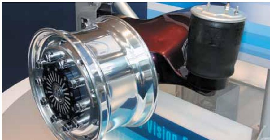
*Производители осевых агрегатов уже на стадии формирования технического задания учитывают тип применяемых колес. Чем меньше неподрессоренные массы, тем меньше нагрузка на элементы подвески и подшипниковые узлы. Именно по этой причине колеса из легких сплавов все чаще и чаще вытесняют более дешевые, но проигрывающие по массе стальные аналоги. Не забудем, что снижение массы осевых агрегатов позволяет увеличить грузоподъемность транспортного средства*
