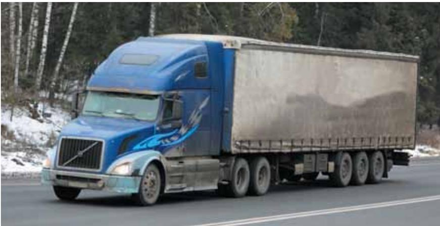
*Если принять в расчет автопоезд в составе трехосного седельного тягача и трехосного полуприцепа (16 колес + 2 запаски), то при оснащении транспортного средства легкосплавными дисками выигрыш по массе составит около 270 кг. Именно на такую величину может быть увеличена полезная нагрузка. Выгода, которую получит перевозчик на сокращении расхода топлива и более длительного срока службы элементов ходовой части, подсчитать гораздо сложнее*
