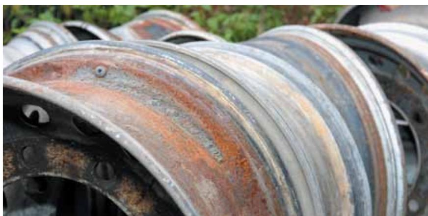
*Стальные колеса (особенно от именитых производителей) выбраковываются нечасто. В отличие от аналогов, изготавливаемых из легких сплавов, у них отсутствует такая проблема, как износ борта обода, состояние которого необходимо периодически контролировать при помощи специальных шаблонов. А вот трещины, возникающие в дисках (у отверстий крепления) и в ободах (у отверстий вентиляей) – обычная причина, по которой стальные колеса отправляются в утиль*
