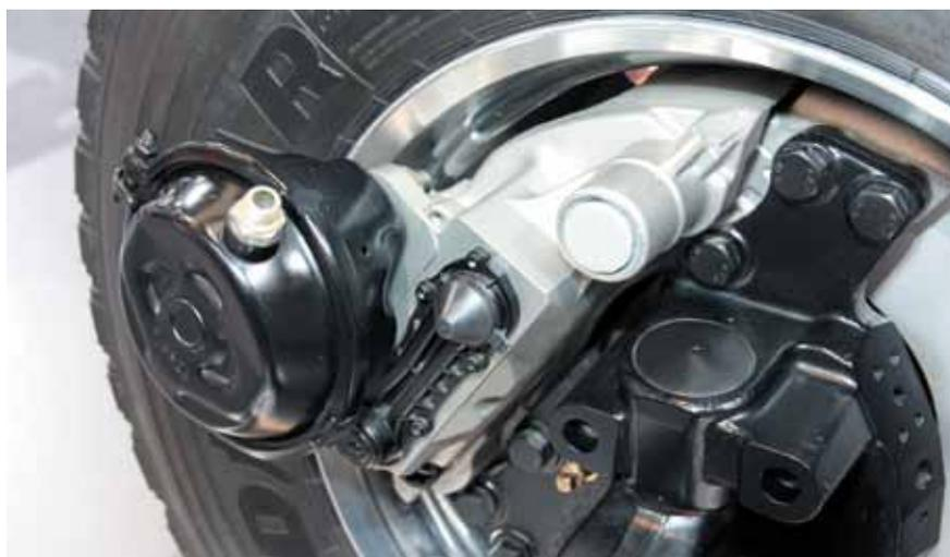
*Расстояние между ободом колеса и тормозным механизмом невелико. Количество тепловой энергии, которая передается колесу при торможении грузовика с применением основной тормозной системы огромно. Это может привести к чрезмерному нагреву колеса, воздуха в шине и ее повреждению*
