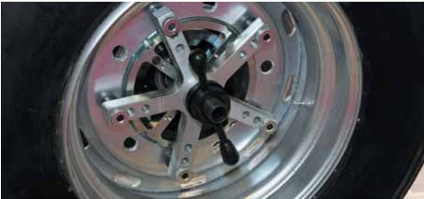
*Для точного позиционирования колеса на балансировочном станке важно использовать качественные адаптеры. Их применение позволяет произвести балансировку колес с высокой точностью. Это благоприятно отразится как на ресурсе шин, подвески транспортного средства, так и на поведении грузовика на дороге. Не станем забывать и то, что отбалансированные «в ноль» колеса вносят свой вклад в уменьшение расхода топлива, что особенно актуально на фоне постоянно растущих цен на горючее*
