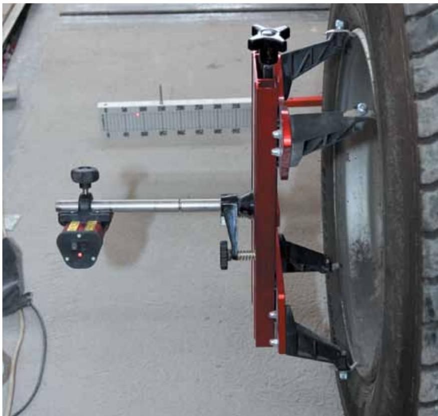
*Колеса грузовика являются элементами, к которым крепится оборудование для измерения углов установки колес. Именно по этой причине инженер СТО обязан проконтролировать их состояние, чтобы исключить любые негативные влияния на точность измерения. Также важно убедиться в том, что на грузовике стоят колеса соответствующей размерности*
